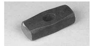
**Martillo albañil:** herramienta provista de mango y dos bocas, una a modo de martillo y la otra a modo de hacha.
