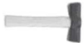
**Maza o mazo:** es una herramienta grande y gruesa con cabeza de acero y mango de madera largo, se utiliza para clavar estacas, golpear punteros, derribar muros, etc.
