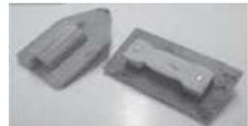
**Llana:** herramienta compuesta de una plancha de acero o plástico y un asa de madera o plástico, se emplea para extender y aplanar morteros y yesos en paredes y techos.
