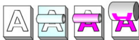
Figura 1: Pasos en la impresión planográfica
