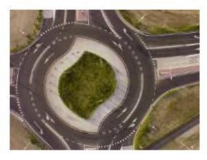
Pues se trata de una evolución de una glorieta convencional, pero a la que se le inyecta las nuevas innovaciones de regulación de intersecciones y a la vez permite mayor grado de confianza, seguridad y comodidad entre los conductores.
